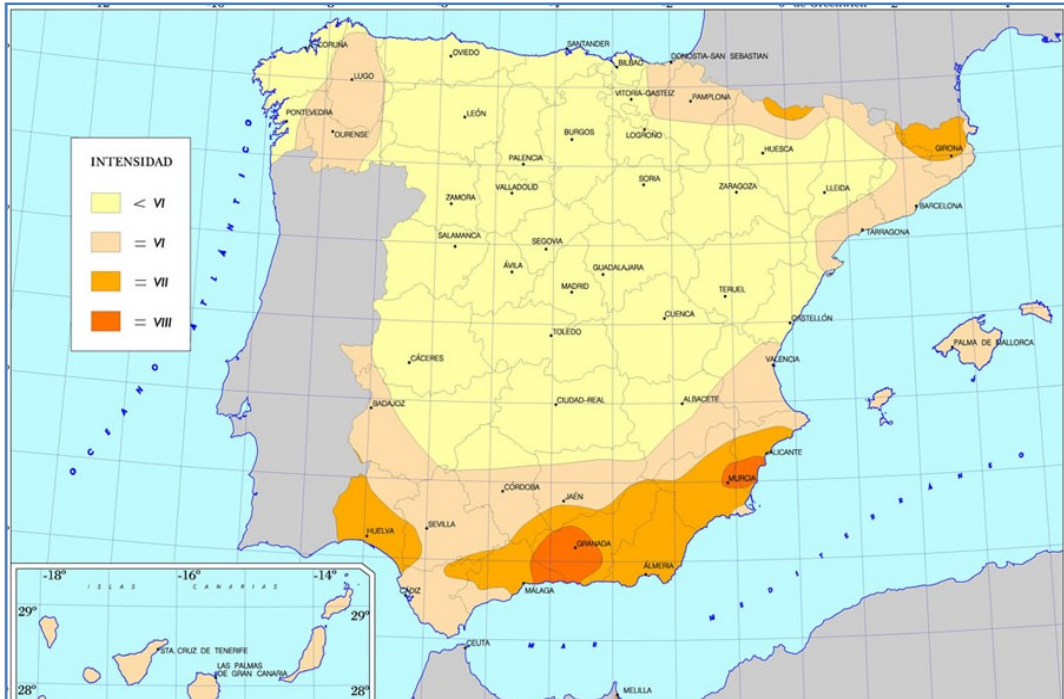
Mapa de peligrosidad sísmica (periodo de retorno 500 años). Fuente: Instituto Geográfico Nacional (IGN).
